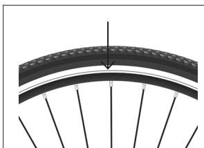
Obr. 2: Kontrolná drážka stavu opotrebovania ráfika.
