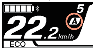
Príklad displeja režimu automatického radenia prevodov
