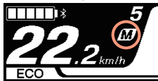
Príklad displeja režimu manuálneho radenia prevodov
